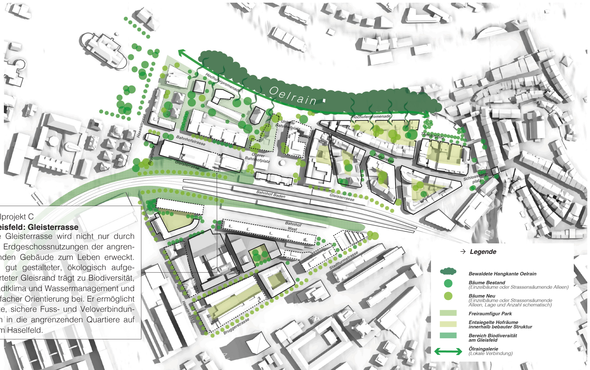
Plangrafische Darstellung Leitsatz 4. Im Plan sind die wichtigsten Erkenntnisse zu verschiedenen Themen räumlich verortet und festgehalten. Die zukünftige Entwicklung soll sich an diesen Erkenntnissen orientieren. Raumkanten und Baufelder sind im Hinblick auf die Abstände zu den Gleisen mit den Vorgaben der SBB bezüglich Lärm und Sicherheit zu koordinieren.
